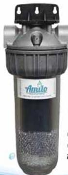
Le système comporte un porte-filtre imprégné à l'argent grâce à une technologie exclusive brevetée pour une action bactériostatique sur tout le corps de filtration, permettant une longévité accrue de la cartouche filtrante. La cartouche de filtration est un assemblage entre charbon granulé de noix de coco, charbon/argent et un alliage cuivre-zinc, le KDF.
